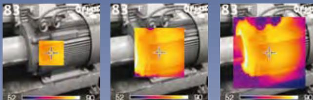
FLIR i60 – la funzione FLIR Fusion Picture-in-Picture modificabile permette di ridimensionare l'immagine termica visualizzandola sull'ampio display a colori LCD da 3.5"
