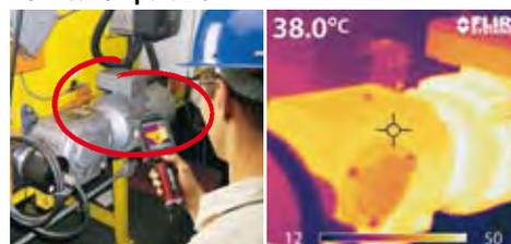
Verifica di un motore elettrico mediante l'utilizzo della termocamera FLIR i60.
